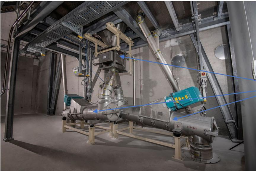
Abscheider für Produkt zu der BB Befüllung mit Dosierschleuse und Verteilervibrationsrinnen (Kontrollsieb ist oberhalb der Bühne angeordnet)
