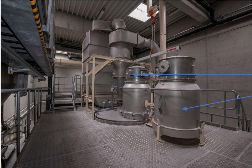
Abscheidebehälter mit Drehfilter um eine Kreuzkontamination von Produkt zu vermeiden. Es ist immer nur ein Filter im Einsatz, je nach Produkt wird der Filter vom Behälter gelöst, gedreht und der zweite wird angeschlossen. So kann auf eine aufwendige Filterreinigung verzichtet werden. Im Hintergrund der Entstaubungsfilter
