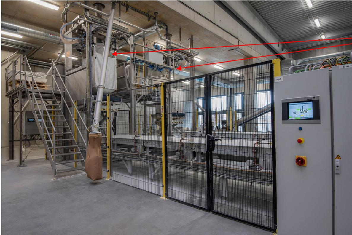
Doppelte Big Bag Befüllstation. Mit hängender Verwiegung. Es können über einen integrierten Hubtisch verschieden große BB befüllt werden. Auf den Hubtischen sind je noch ein Vibrationstisch zum Verdichten der BB und ein Bandförderer montiert. BB – Anbindung über aufblasbare Manschette. Leistung bis zu 15 BB/h je nach Größe und Produkt.
