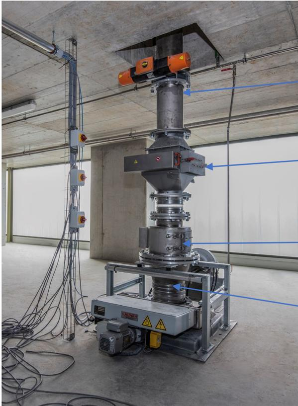
Fallrohr aus den Silos. Dient als Verbindung von Silo zu LKW.
